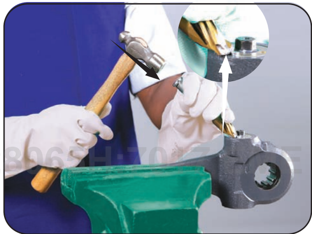
Remove rivet (1)
