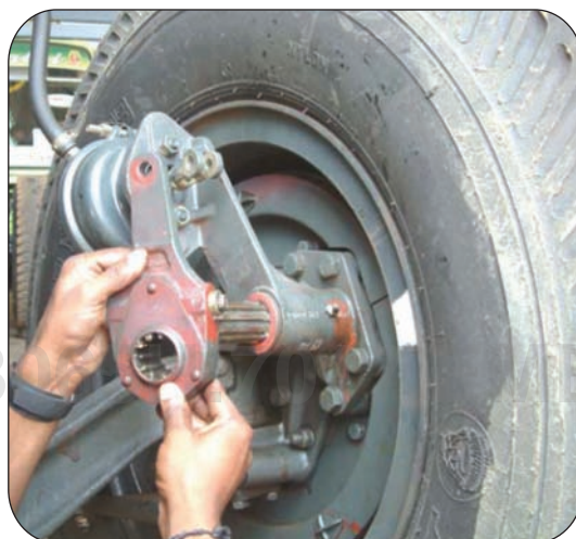
Remove manual slack adjuster
